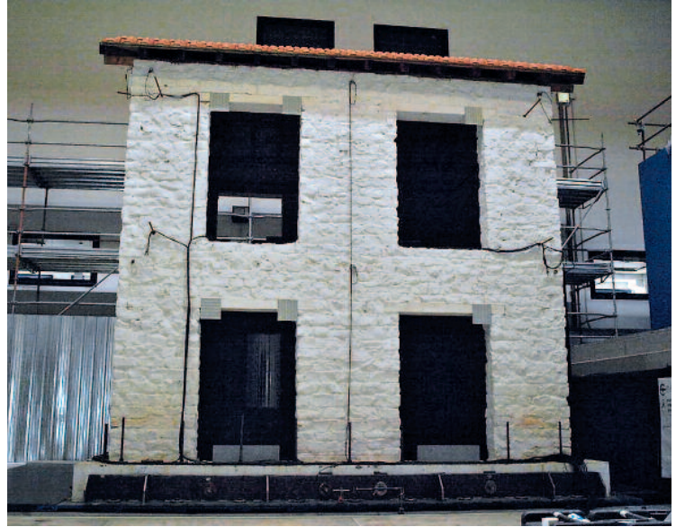
Fig. 4 Secondo edificio in muratura di pietra posizionato sulla tavola vibrante all'interno del TREES LAB (Progetto esecutivo Eucentre-DPC, programma di ricerca coordinato dal Prof. G. Magenes).
