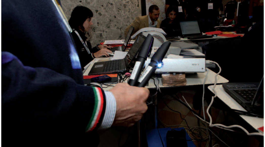
Fig. 7 Penne elettroniche per la compilazione delle schede AeDES di rilievo del danno e dell'agibilità.
