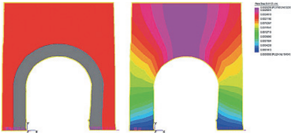
Figura 27 Modello numerico-strutturale bidimensionale in ambiente Straus7 dell'Arco d'Augusto di Rimini ottenuto con la Procedura FEM 2D di Serpieri M. (2005) (a sinistra), Stato deformativo a causa del peso proprio dell'arco (a destra).
