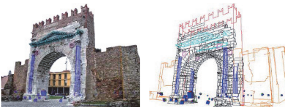
Figura 9 Vista Prospettica da un punto di ripresa con sovrapposizione Modello Vettoriale e posizione/assetto di vari punti di presa del fronte sud dell'Arco d'Augusto di Rimini ottenuto in output dal processo di restituzione fotogrammetrica (a sinistra), Vista Prospettica da un punto di ripresa del Modello Vettoriale con posizione/assetto di vari punti di presa (a destra). Software PhotoModeler - Serpieri M. (2005) - Procedura FEM 2D.
