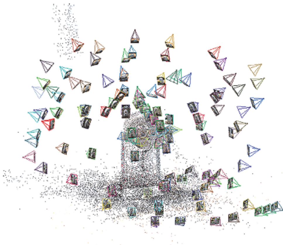
Figura 4 Restituzione Fotogrammetrica - Nuvola di punti sparsi della fontanella con individuazione punti di presa.
