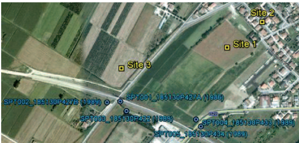
Figura 13 Localizzazione dei siti in cui sono state eseguite le prove SPT nelle campagne geognostiche del 1986 e 1989 e la posizione delle aree maggiormente colpite dalla liquefazione a San Carlo, investigate dalla squadra "Geo" di Eucentre, specificatamente il Sito 1, il Sito 2 ed il Sito 3.
