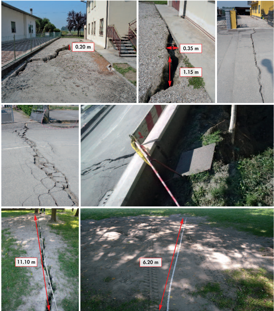
Figura 10 Effetti della liquefazione al Sito 2 (San Carlo) investigato dalla squadra "Geo" di Eucentre dopo l'evento del 20 maggio: danni a strutture ed espulsione di materiale sabbioso da fessure nel terreno.
