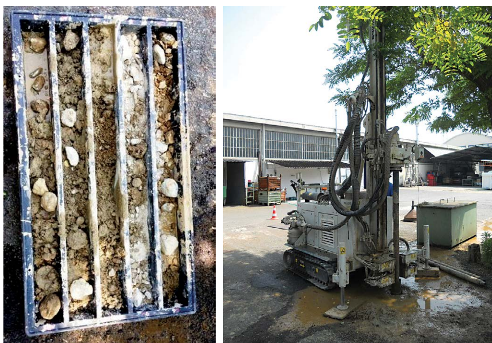
Figura 10 Sondaggio a carotaggio continuo.
