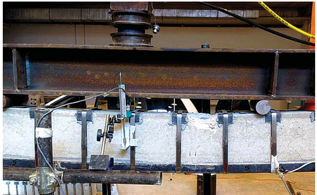
Figura 18 Meccanismo di rottura.
