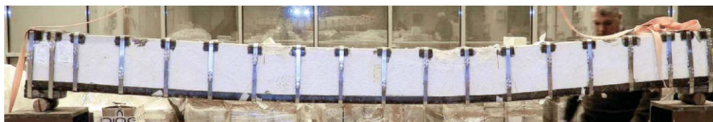
Figura 24 Deformazione residua della trave.
