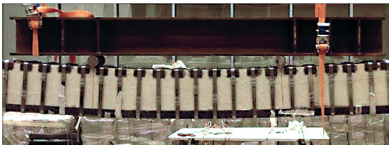
Figura 11 Provino FX 3N P10_1 flesso durante il test (in alto).
