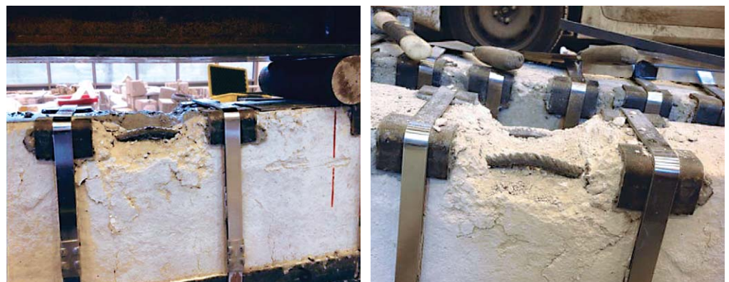
Figura 19 Rottura corrente compresso (a sinistra).
