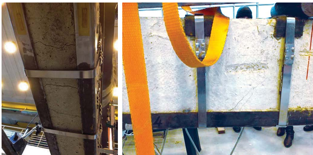
Figura 21 Meccanismo di rottura.
