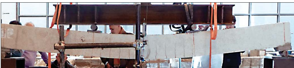
Figura 5 Trave flessa durante il test.
