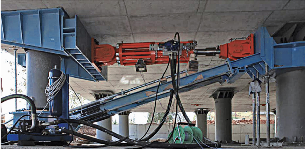
Figura 9 Test in situ di un edificio isolato de L'Aquila.
