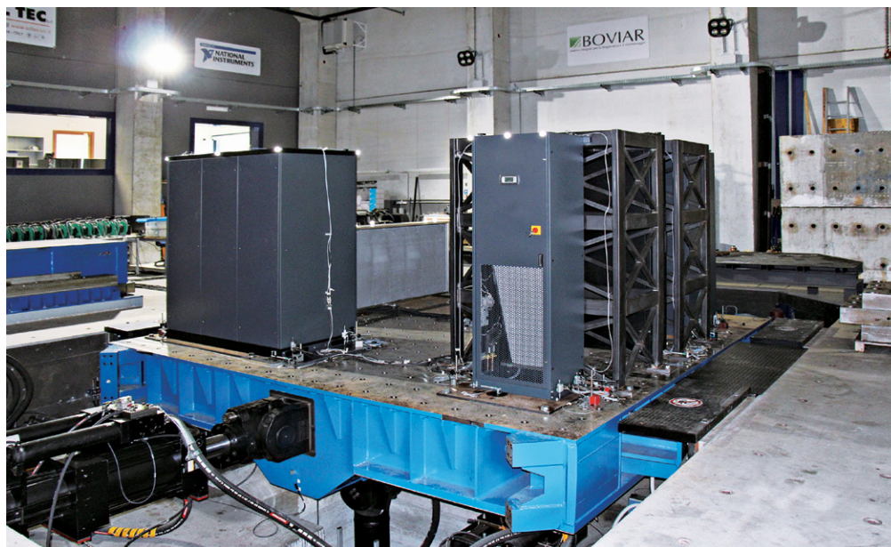
Figura 2 Viste d'insieme dei provini posizionati sulla tavola vibrante multiassiale.
