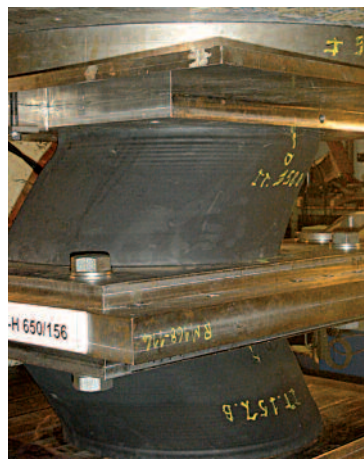
Fig. 14 Prove di qualificazione eseguite sugli isolatori elastomerici presso il laboratorio FIP Industriale di Selvazzano Dentro (PD).
