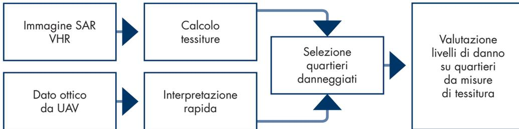
Fig. 6 proposta di schema di fusione tra dati ottici e radar per la valutazione rapida del danno a livello di quartiere.
