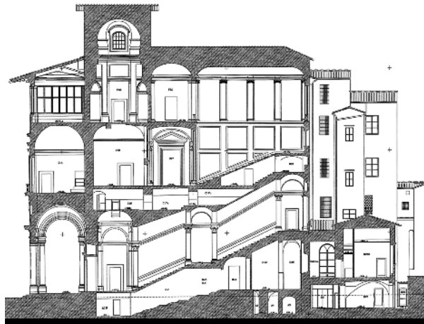
Fig. 5 Sezione trasversale A-A, in corrispondenza dello Scalone vasariano (in Cecchi e Paolucci, 2007).
