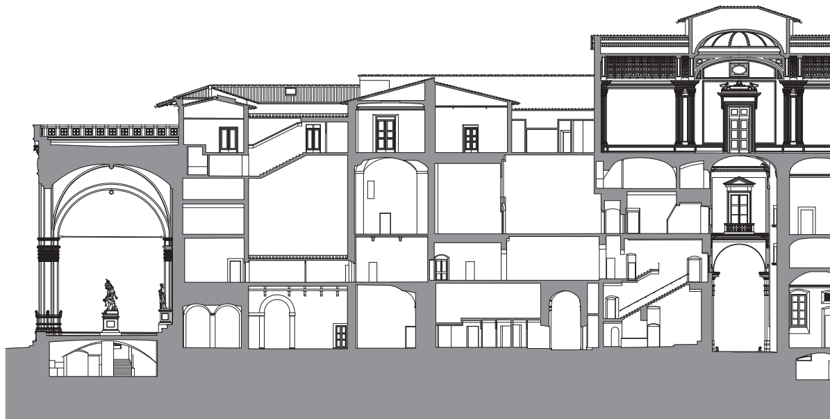
Fig. 7 Sezioni longitudinali D-D ed E-E della Fabbrica Vasariana degli Uffizi (in Cecchi e Paolucci, 2007).
