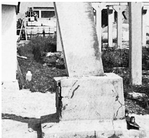
Fig. 13 Collasso del plinto per una forza inclinata pari a circa 90 kN ( M = 360 \text{ kNm} ), da Mori & Pereswiet-Soltan (1981).
