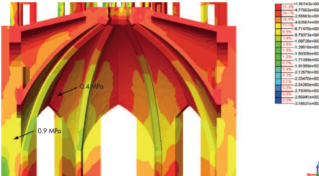
Figura 22 Andamento degli sforzi principali di compressione [N/cm 2 ] all'interno del tiburio, Caso 4, analisi non lineare.
