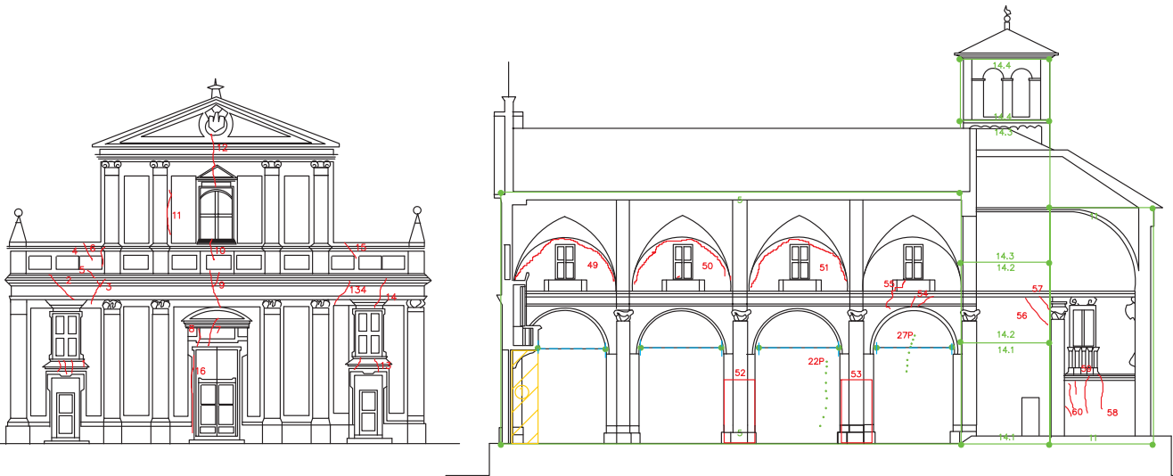
Figura 3 Archivio delle chiese danneggiate dal terremoto del 1987 – Provincie di Modena e Reggio Emilia - Rilievo del quadro fessurativo: Duomo di Finale Emilia.
