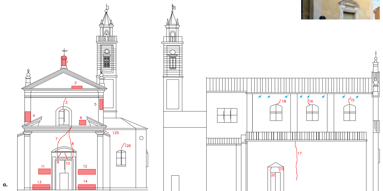
Figura 9 S. Rosario Finale Emilia: a) rilievo del quadro fessurativo in facciata e nella parete laterale dopo il sisma del 1987; b) danno osservato in seguito agli eventi del 2012.
