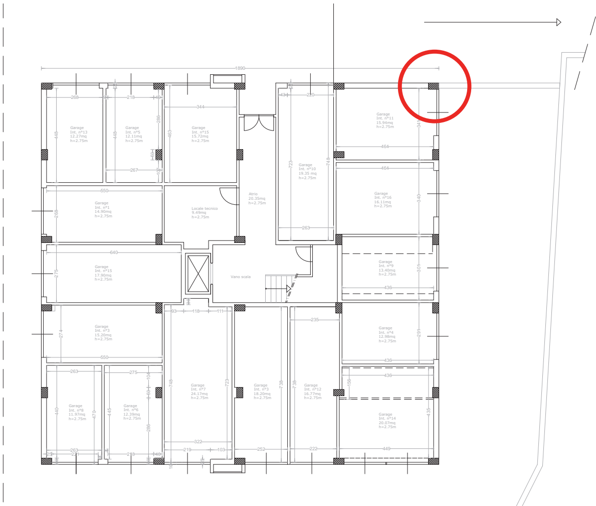
Figura 1 Punto di contatto tra il muro di contenimento della rampa d'ingresso e l'edificio.
