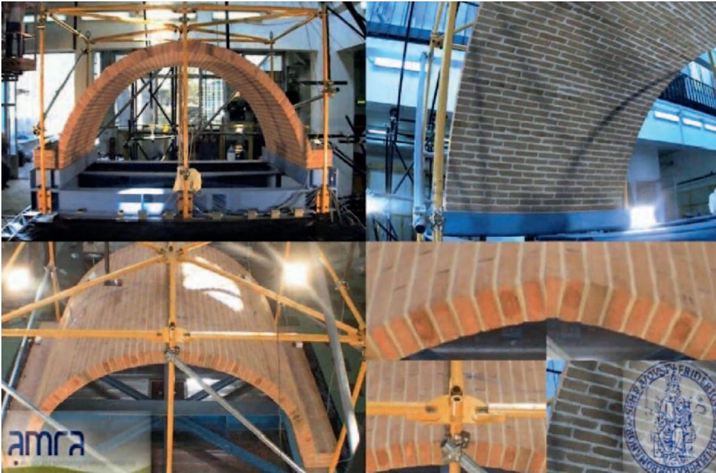
Foto 4 Prova sperimentale su tavola vibrante: volta in mattoni pieni.
