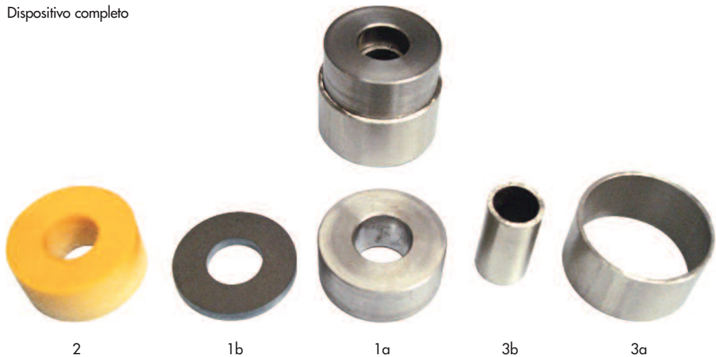
Figura 1 Elemento di smorzamento assemblato (sopra) e singoli componenti (sotto). Si veda la Figura 2 per ulteriori dettagli.
