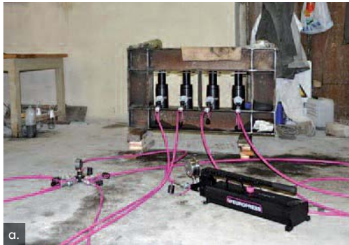
Figura 10 a) test a piè d'opera dei martinetti; b) martinetti in opera.
