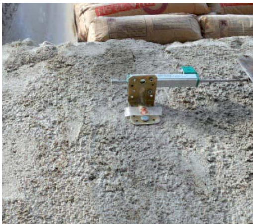
Figura 13 Posizionamento dei traduttore n. 7, 8.
