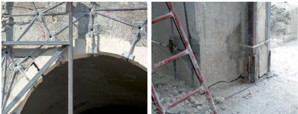
Figura 25 Prova su arco rinforzato: lesione n. 3 e 4, slittamento dell'elemento superiore e fessurazione sezione in chiave (a sinistra).
