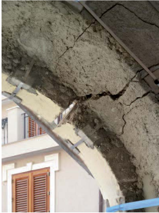
Figura 29 Prova su arco rinforzato danneggiato: apertura lesione nella sezione delle reni (a sinistra).
