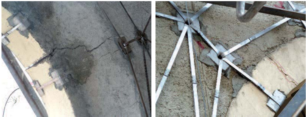
Figura 23 Prova su arco rinforzato: lesione n. 1, sezione ai reni.
